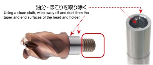
**2** 締め付ける際、刃先に直接素手で触れるとけがをする可能性があるため、保護手袋など保護具を使用してください。すきまが残った状態から付属のスパナを使用して、ヘッドとホルダの端面が密着するまで締め付けてください。
