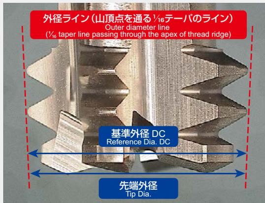
基準外径DCと先端外径が異なるため、呼び径D<sub>1</sub>を補正してプログラミングする必要があります。呼び径D<sub>1</sub>はめねじの谷の基準径(タップの基準径)に相当します。
