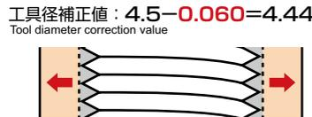
加工径拡大 ボルト、通りゲージ通過可能
